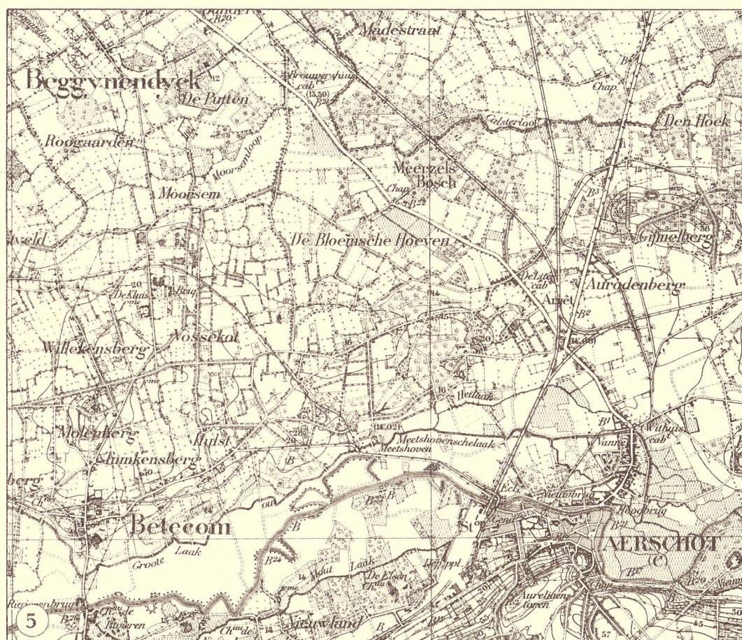
Éénkleurige kaart op 1:40.000, in 75 bladen, verkregen 't zij door etsoverdruk, 't zij door verkleining der tekening op 1:10.000. Carte au 1:40.000, monochrome, en 75 feuilles, obtenue soit par report de gravure, soit par réduction d'un dessin fait au 1:10.000.
