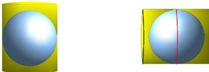
Figure 7. Surface développable cylindrique tangente (ligne de tangence en rouge) en aspect direct (gauche, tangent à l'équateur) et transverse (droite, tangent à un méridien).
