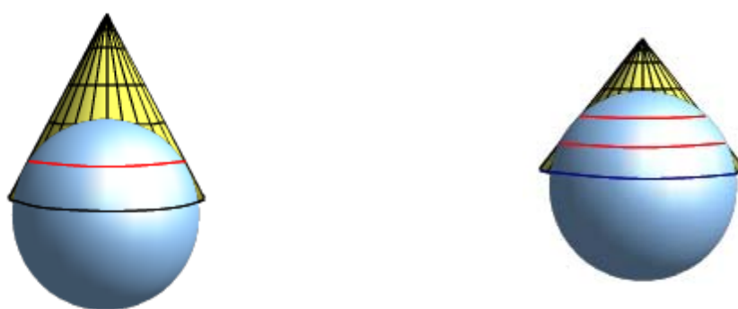
Figure 9. Surface développable conique en aspect direct, tangente (gauche, à un parallèle) et sécante (droite, à deux parallèles).
